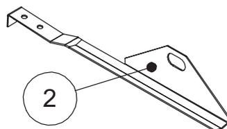
Крепление для одной трубки.
