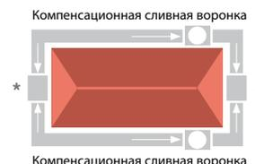
Если водосточные желоба образуют «прямую линию без уклона», как показано на рис. А, и их длина не превышает 12 м, можно использовать сливную воронку на клеевых соединениях. Компенсация будет происходить на свободном конце водосточных желобов вдали от сливной трубы.
