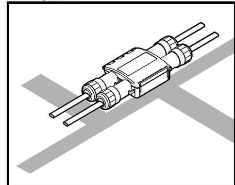
Четырехпроводное соединение греющего кабеля
