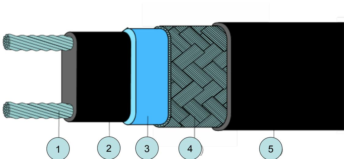
1. Медные провода большого сечения
