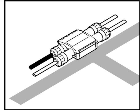
Т-образное соединение греющего кабеля с кабелем питания
