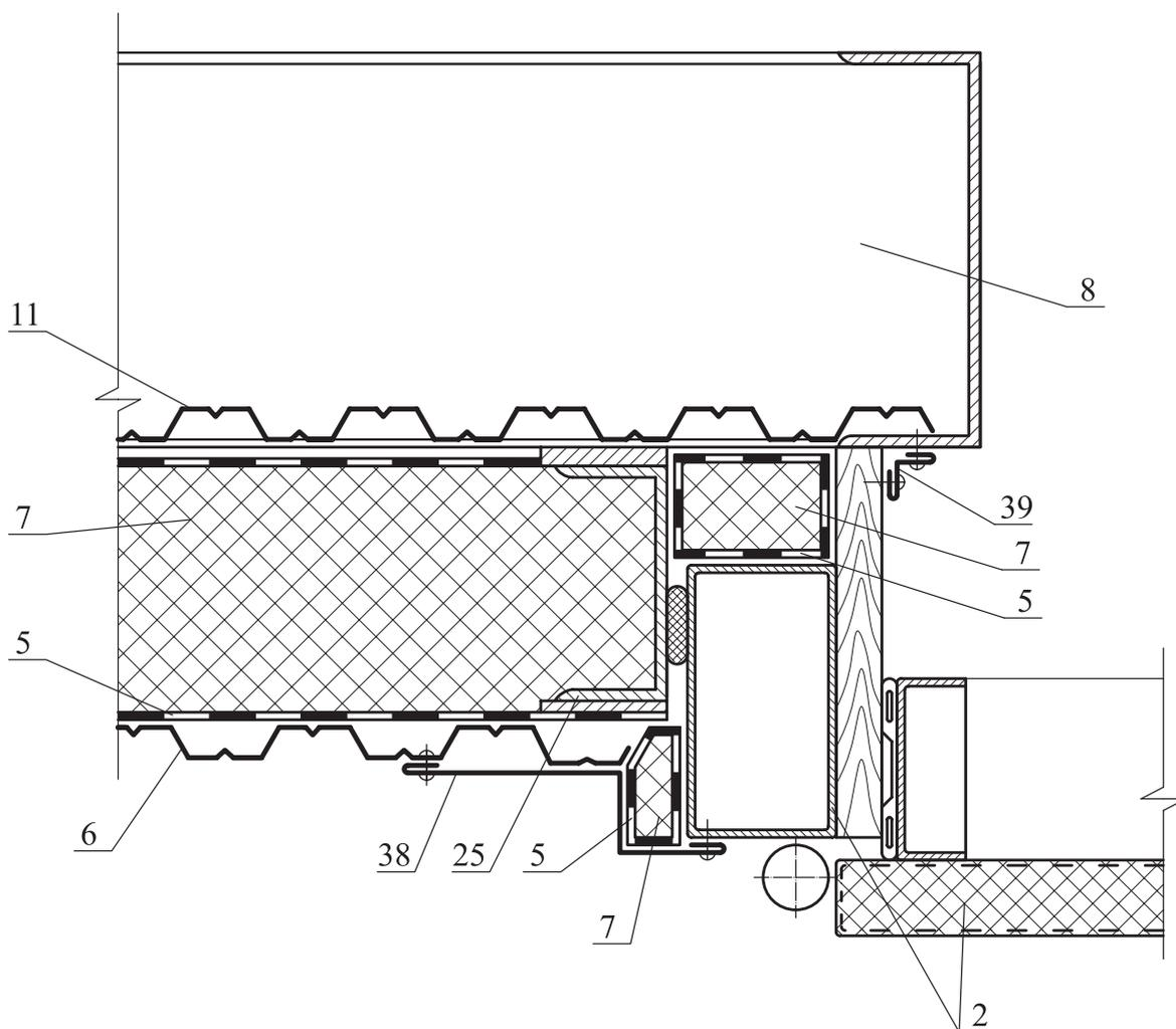
2-Рама и полотно ворот по сети 1.435-28; 5-Ветрозащитная пленка (см. п.2.1.1); 6-Наружная обшивка из оцинкованного стального профлиста; 7-Утеплитель из плит марки «ТЕХНОЛАЙТ»; 8-Каркас панели; 11-Внутренняя обшивка; 25-Термовкладыш из бакелизированной фанеры; 38-Нащельник НЗ; 39-Нащельник Н4.
