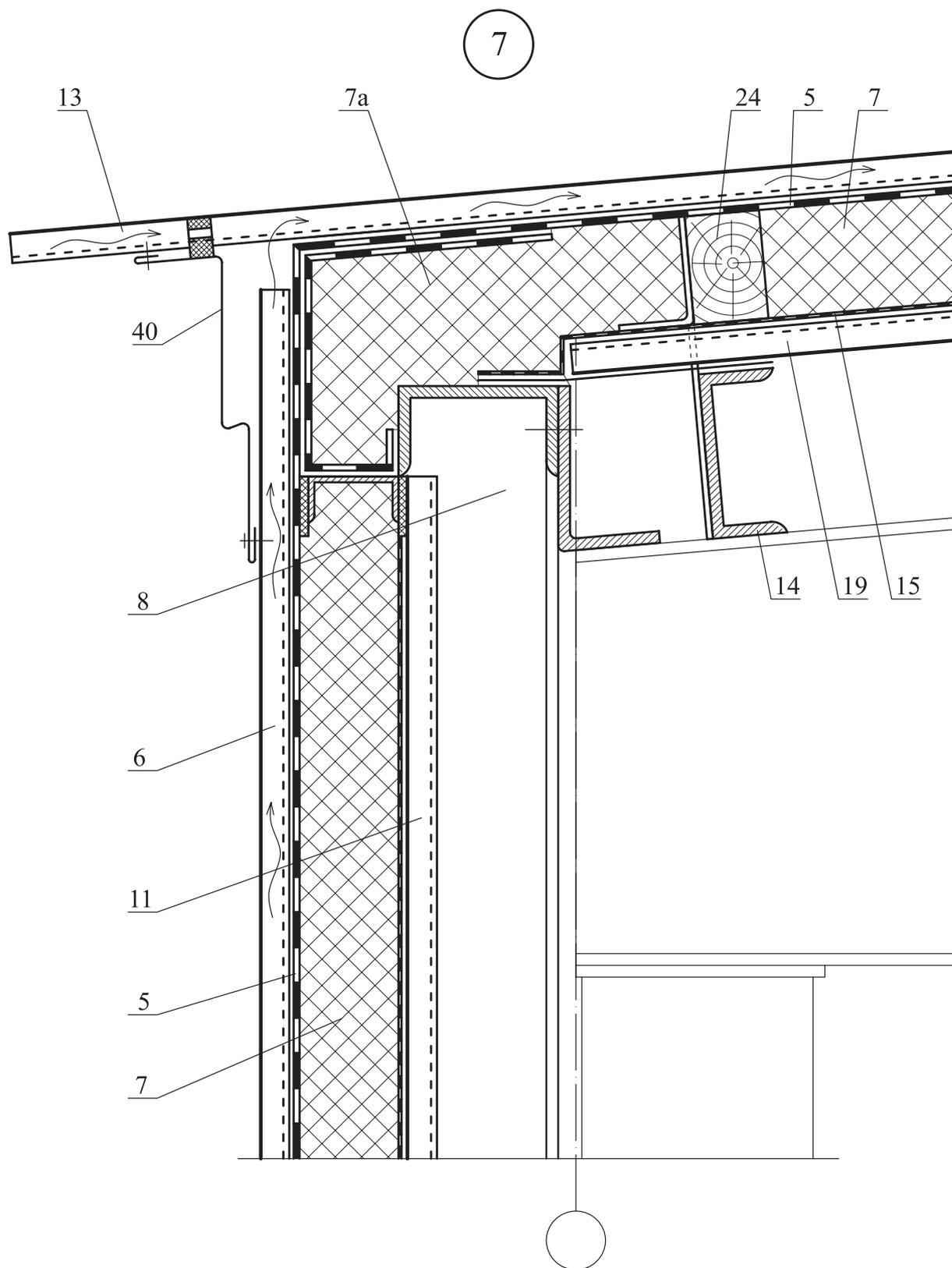
5-Ветрозащитная пленка (см. п.2.1.1); 6-Наружная обшивка из оцинкованного стального профлиста;
