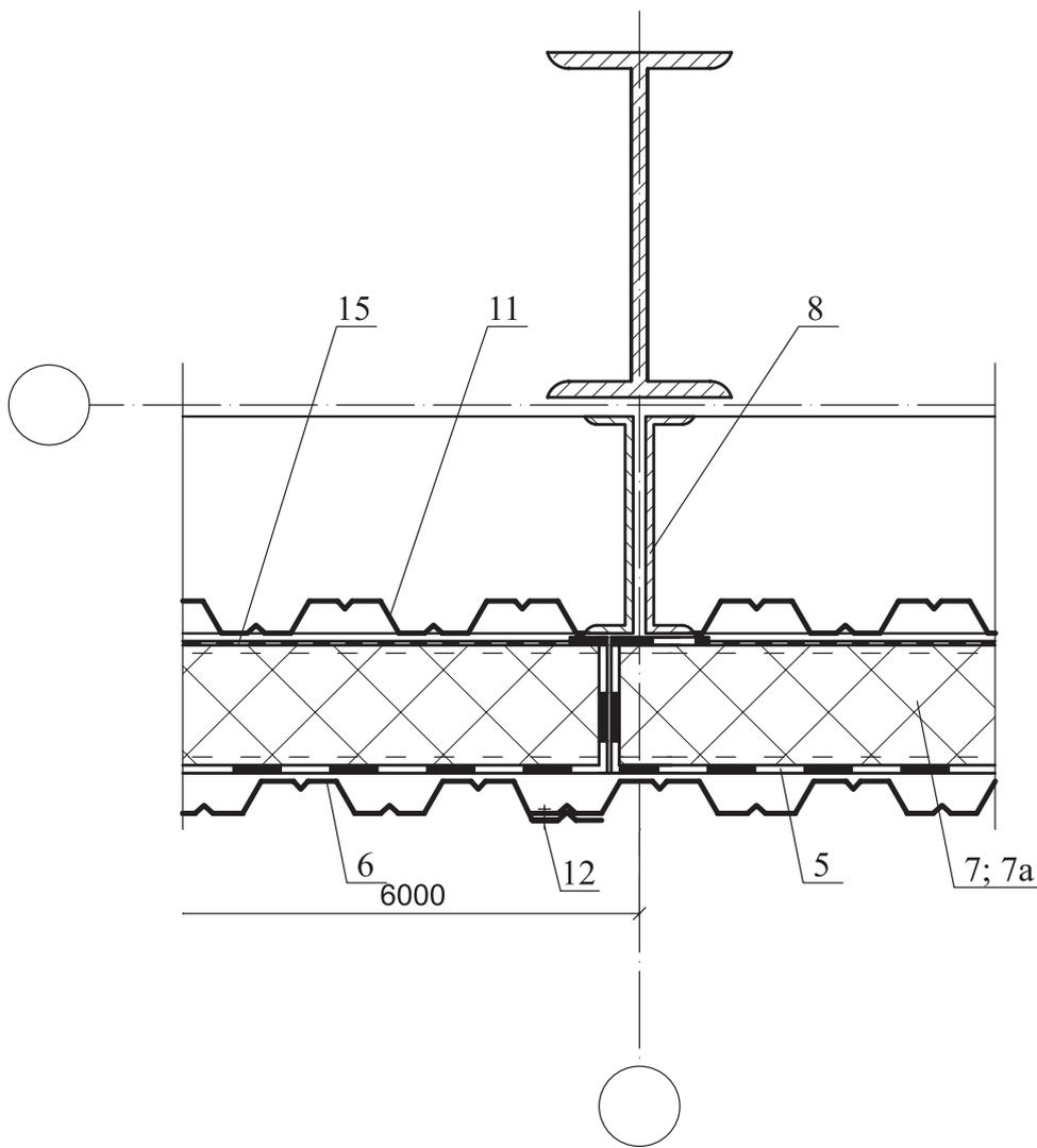
5-Ветрозащитная пленка (см. п.2.1.1); 6-Наружная обшивка из оцинкованного стального профлиста;
