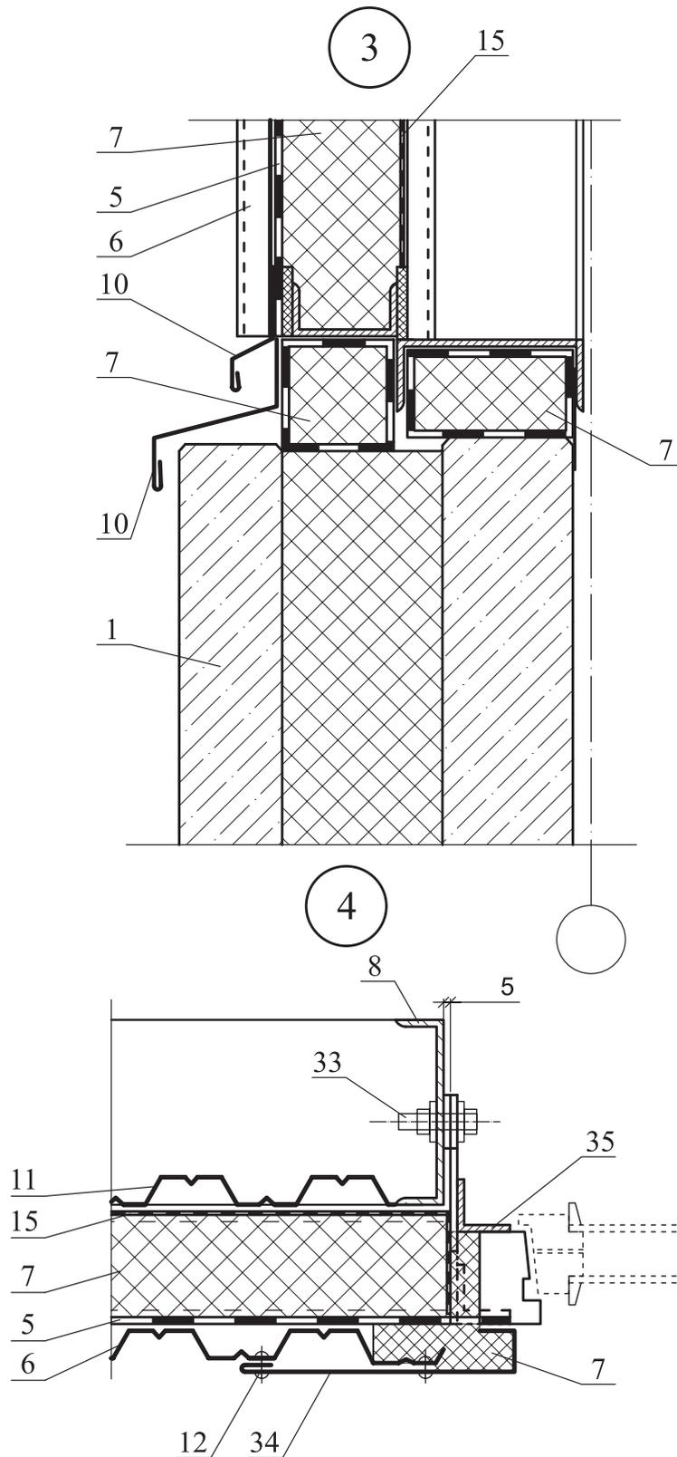
1-Панель стеновая цокольная; 5-Ветрозащитная пленка (см. п.2.1.1); 6-Наружная обшивка из оцинкованного стального профлиста; 7-Утеплитель из плит марки «ТЕХНОЛАЙТ»; 8-Каркас панели; 10-Слив С1; 11-Внутренняя обшивка; 12-Заклепка; 15-Пароизоляция (см. п.2.1.1); 33-Болт М16х50 с шагом 600; 34-Нащельник Н2; 35-Элемент крепления окна У2; У3 с шагом 600.
