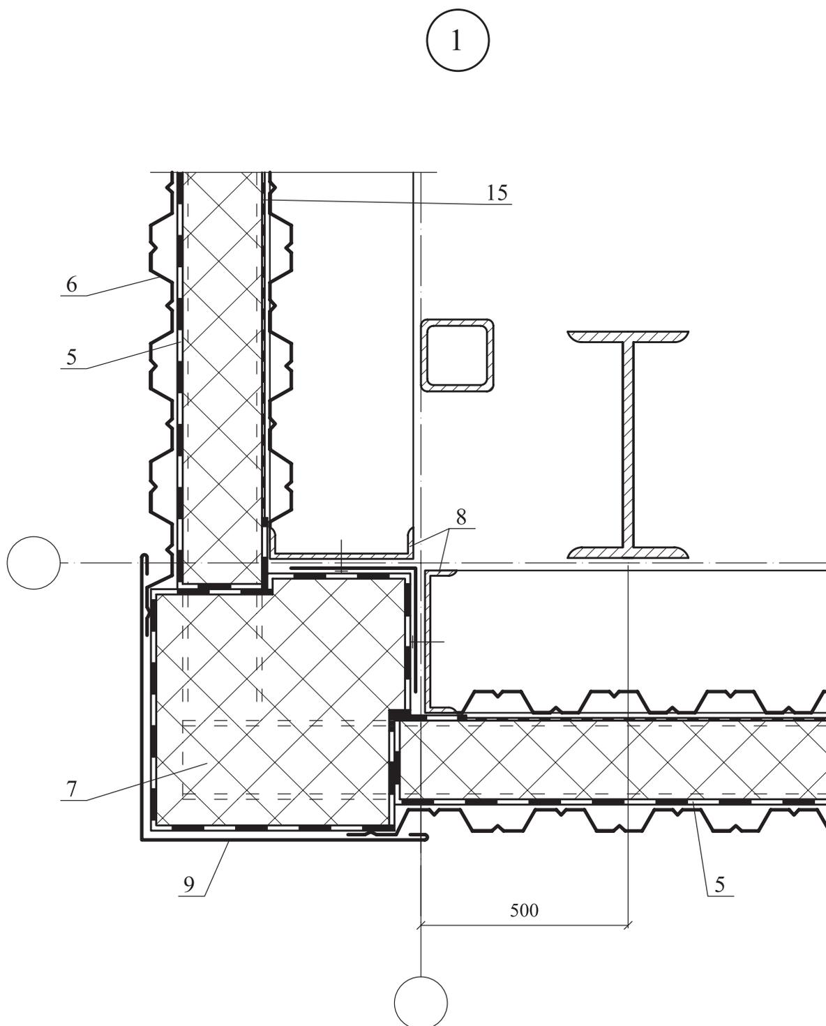
5-Ветрозащитная пленка (см. п.2.1.1); 6-Наружная обшивка из оцинкованного стального профлиста;
