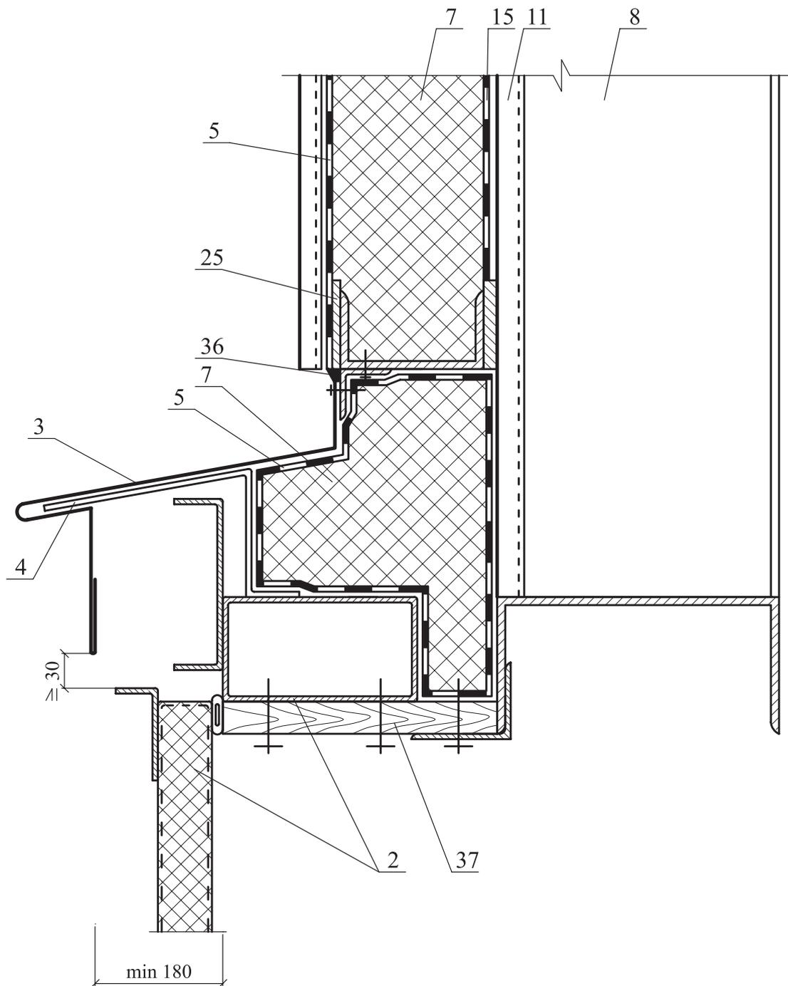
2-Рама и полотно ворот по сети 1.435-28; 3-Слив С2; 4-Костьль МС-1 с шагом 700 мм см в серии 1.435-28; 5-Ветрозащитная пленка (см. п.2.1.1); 7-Утеплитель из плит марки «ТЕХНОЛАЙТ»; 8-Каркас панели; 11-Внутренняя обшивка; 15-Пароизоляция (см. п.2.1.1); 25-Термовкладыш из бакелизированной фанеры; 36-Мастика; 37-Доска.
