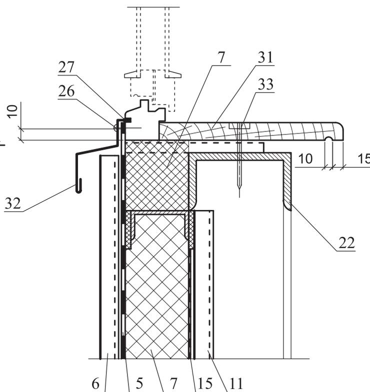
5-Ветрозащитная пленка (см. п.2.1.1); 6-Наружная обшивка из оцинкованного стального профлиста;
