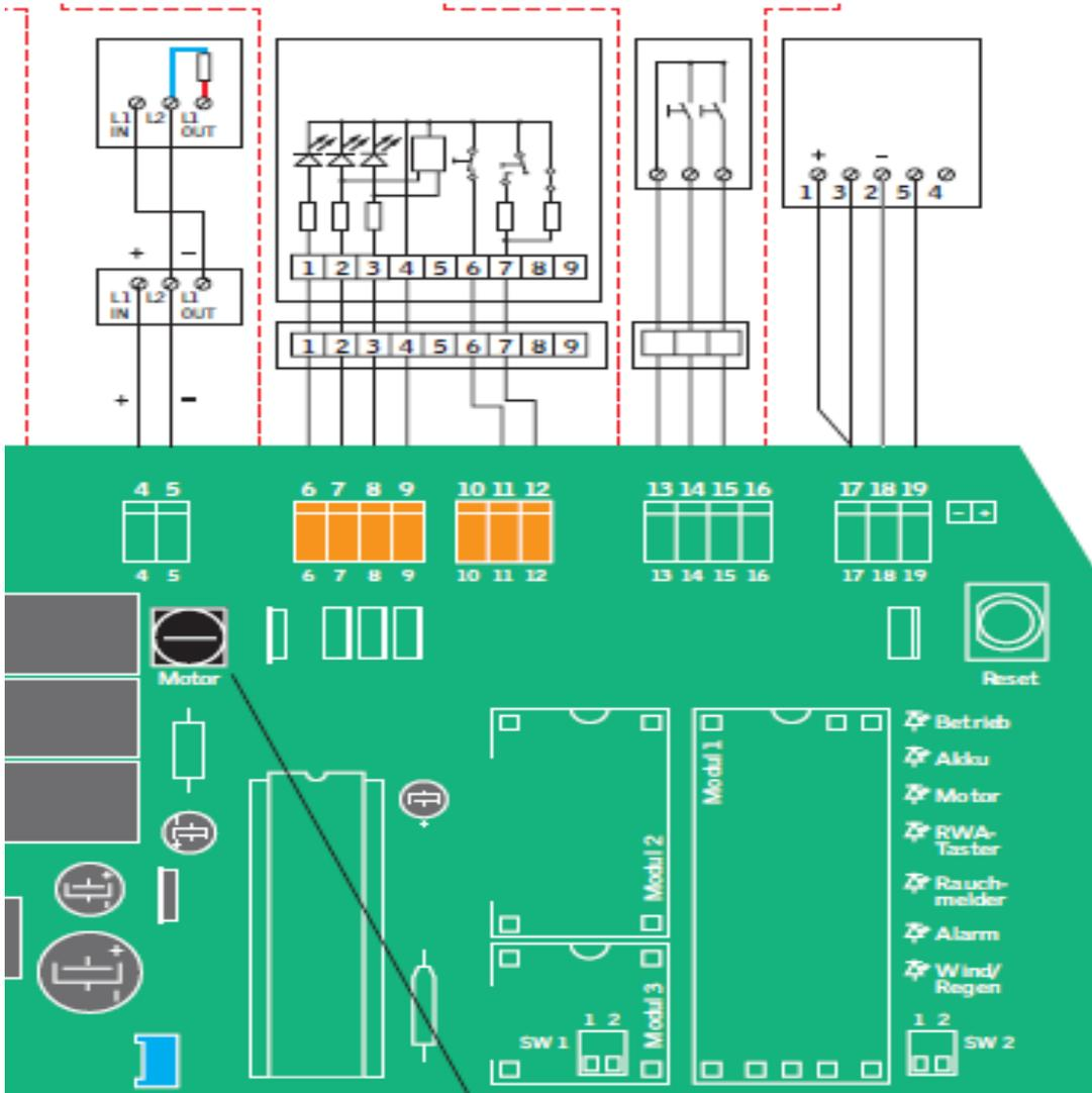
Предохранитель привода окна
