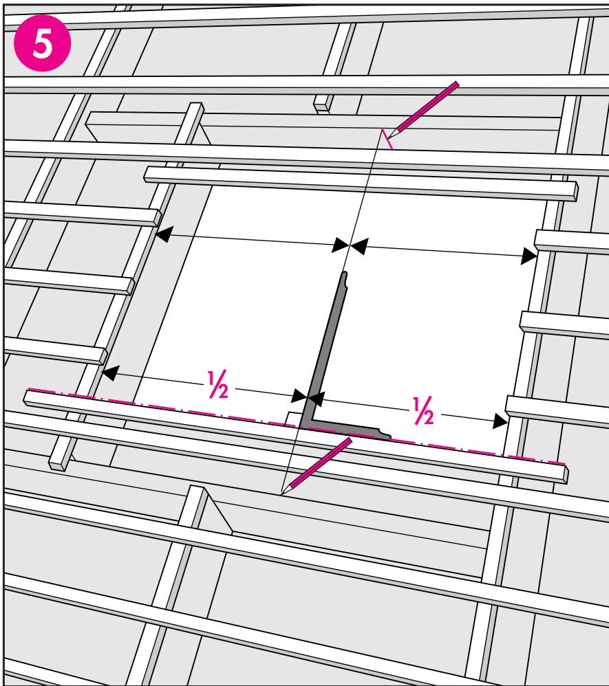
**ENGLISH:** Mark position of EBY on face of trimmers.**DEUTSCH:** Die Position des EBY auf den Wechseln markieren.**FRANÇAIS :** Marquer la position de l'EBY sur le dessus des chevêtres.**DANSK:** Mærk op på udveksling for placering af EBY.**NEDERLANDS:** Markeer de positie van de EBY op de raveelbalken.**NORSK:** Merk opp for plassering av EBY.**SVENSKA:** Märk upp på avväxlingen för placering av EBY.
