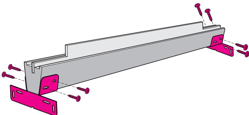
**ENGLISH:** Fix brackets.**DEUTSCH:** Montagebeschläge befestigen.**FRANÇAIS :** Fixer les pattes d'attache.**DANSK:** Monteringsbeslag fastgøres.**NEDERLANDS:** Bevestig de beugels aan de uiteinden.**NORSK:** Fest monteringsbeslagene.**SVENSKA:** Skruva fast monteringsbeslagen.
