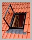
Окно-люк для выхода на кровлю. Для неотапливаемых помещений под кровлей, в которых необходим технологический выход на крышу. Открывается по боковой оси. Имеет стеклопакет и встроенный оклад. Для кровельного материала с высотой профиля до 60 мм.
