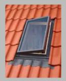
Окно-люк для освещения и проветривания неотапливаемых, нежилых помещений под кровлей. Модель VLT 025 (45 x 55 см) и модель VLT 029 (45 x 73 см) открываются по верхней или по боковой оси. Модель VLT 033 (85х85 см) открывается по боковой оси. Рамафиксируется в трех положениях для проветривания.
