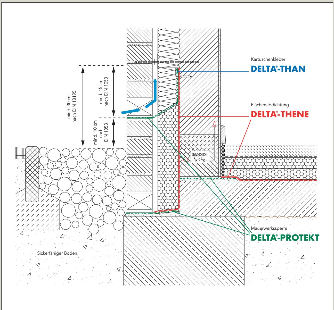
Die **DIN 18195** regelt die verschiedenen Arten der Bauwerksabdichtungen, die dafür geeigneten Materialien und deren Schutz. Die Mauerwerksnorm **DIN 1053** beschreibt, wie die Abdichtung des Sockelbereichs von zweischaligen Wänden auszuführen ist. Die **DIN 4095** regelt die Ausführung und Bemessung von Dränanlagen.
