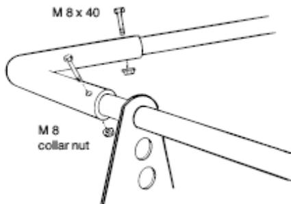
4. 90° изгиб трубы. Закрепите изгиб трубы резьбовым соединением.
