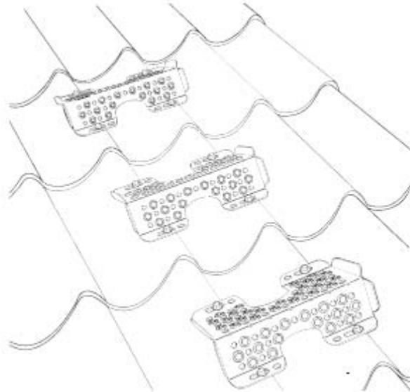
Закрепите шаги на кровельный лист, используя 4 самореза (входят в комплект) диаметром 6.3. Если толщина стального листа больше, чем 0,7 мм могут быть использованы винты. Ступеньки сконструированы с двумя пешеходными гранями. Это позволяет поворачивать их, чтобы они подходили к кровлям с разным наклоном. Используйте широкую грань ступеньки для наклона до 35 градусов. Для более крутых наклонов рекомендуется использовать маленькую грань. Ступенька подходит для наклона до 55 градусов.
