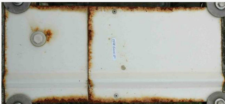
Образец N04H (основа – Z100*) После 5 лет испытаний, угол – 90°
