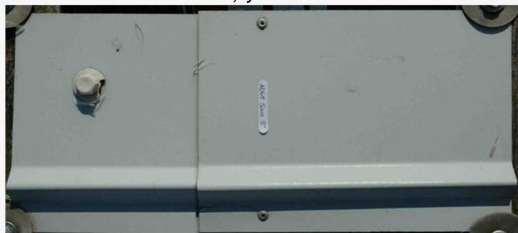
Образец N04H (основа – Z275**) После 5 лет испытаний, угол – 90°
