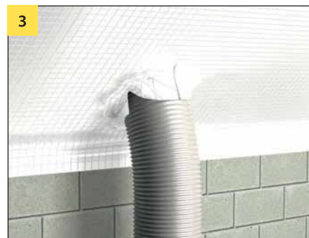
Вентиляционная проходка (Шаг 2 – нанесение 1-го слоя DELTA®-LIQUIXX и армирующей ткани)
