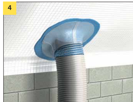
Вентиляционная проходка (Шаг 3 – нанесение второго слоя пасты)
