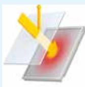
Внешнее стекло стеклопакета имеет низкоэмиссионное покрытие Low-E, которое пропускает в помещение тепло, но не выпускает его обратно. Стеклопакеты заполнены инертным газом для теплоизоляции.
