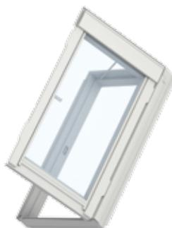
Мансардное окно и одновременно выход на крышу для отапливаемых помещений. Открывается по боковой оси. Газовая пружина в верхней части оконной створки облегчает ее открывание. Изготовлено из клееной древесины, с лаковым покрытием.
