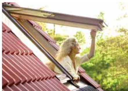
Две ручки: верхняя и нижняя. Два способа открывания: традиционный (по центру) и панорамный (наружу по верхней оси, на 30–45°). Открывает великолепный обзор. Рекомендуется для кровель с малым уклоном (15–55°). Может служить аварийным и эксплуатационным выходом. Есть опция установки электрооборудования.
