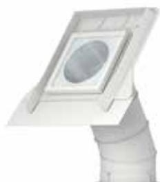
В глубине дома бывают помещения, где установка окон невозможна. Провести солнечный свет в такие комнаты помогает световой туннель. Конструкция устанавливается в крышу так же, как мансардное окно VELUX. В потолок встраивается плафон диаметром 35 см. Эти два элемента соединяются друг с другом с помощью трубы со светоотражающим покрытием.
