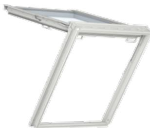
Мансардное окно со всеми характеристиками и функциями окна GPL и одновременно аварийный выход на крышу. При нажатии ручки для аварийного выхода окно автоматически открывается газовыми пружинами. Подходит для всех отапливаемых мансардных помещений. Увеличенный угол открывания — 70°. Изготовлено из клееной древесины, с лаковым покрытием.
