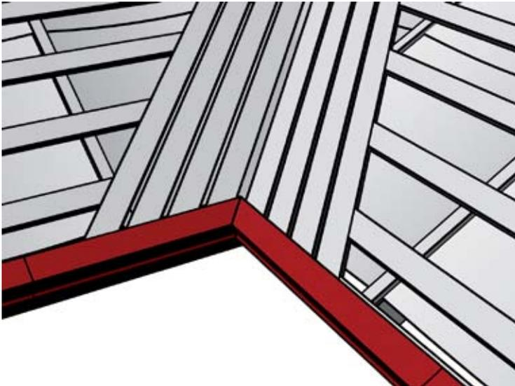
Доски основания укладываются на одном уровне с обрешеткой по всей поверхности кровли. Следует оставлять вентиляционные зазоры около 20 мм между планками ендовы.
