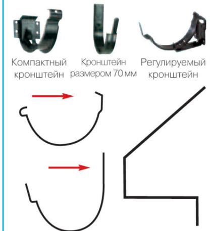
Для выполнения крепления к вертикальной бордюрной рейке Вы можете использовать кронштейны размером 70 мм, компактные или регулируемые кронштейны.
