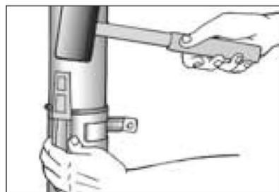
Установите всю водосточную трубу целиком. Сожмите края фиксатора вместе, обеспечивая надежный обхват трубы, и найдите фиксирующий клин для соединения краев. Для забивки клина используйте деревянный брусок или резиновую колотушку.
