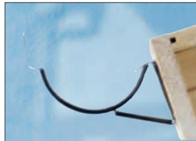
Для регулируемых кронштейнов: измерьте угол бордюрной рейки. Зафиксируйте угол кронштейна с помощью монтажной пластины. Проверьте правильность определения угла, прислонив кронштейн к бордюрной рейке. Далее отрегулируйте остальные кронштейны; после этого Вы можете выполнить их установку и монтаж водосточного желоба таким же образом, как описано для обычных (нерегулируемых) кронштейнов. Регулируемые кронштейны могут быть использованы для крепления на вертикальных бордюрных рейках.
