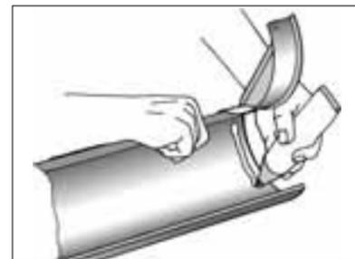
Установите торцевую заглушку на конечную часть водосточного желоба; нанесите на поверхность соединения полоску из герметика для металла.
