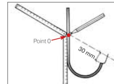
Нанесите точную копию угла, образованного складным метром, на лист бумаги и продолжите карандашом линию, соответствующую скату кровли. Положите монтажный кронштейн на лист бумаги, совместив его прямой отрезок с вертикальной линией рисунка. Разместите кронштейн таким образом, чтобы кончик крюка находился на 30 мм ниже линии, продолжающей скат кровли (пунктир).
