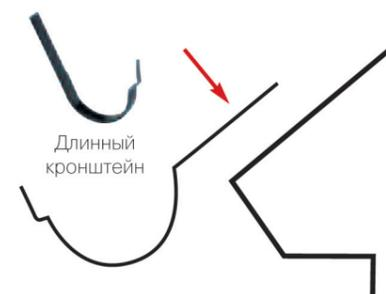
При выполнении крепления к кровле используйте кронштейны размером 160 или 210 мм. (При необходимости обеспечения соответствия уклону ската согните кронштейн.) Примечание: кронштейны размером 160 мм могут использоваться только в случае, если уклон ската крыши составляет примерно 18 градусов или менее; если уклон ската больше 18 градусов, следует использовать кронштейны размером 210 мм.
