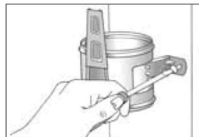
Жестко прикрепите фиксатор для водосточной трубы к стене, непосредственно ниже уровня собранного колена трубы. Следующий фиксатор следует устанавливать строго по вертикальной линии ниже первого элемента и т. д. Максимальное расстояние между двумя соседними фиксаторами не должно превышать 2 метров.
