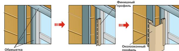
В верхнем и нижнем околооконном профиле в полках откосов надрежьте и отогните.
