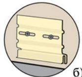
Установку отлива начинают с угла дома. Сначала изготавливается угловой элемент (как показано на рисунке), который крепится на углах дома. Последующие отливы устанавливаются с нахлестом рабочей поверхности = 25 мм.
