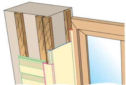
Монтаж происходит так же, как и в выше указанных случаях, только вначале монтируется финишный профиль, затем откос, и в завершение устанавливаем наличник.
