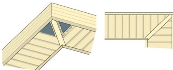
Софлит устанавливается между молдингом и J-фаской. Технология монтажа соффита очень проста: отрезается панель нужного размера за вычетом зазора на установку. Один конец заводится в молдинг, другой в J-фаску и фиксируется саморезом. Следующий софлит монтируется таким же образом и защелкивается в замок первого, и так далее.
