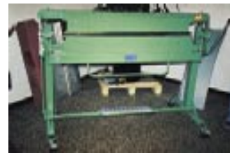
Станок коробчатого сгиба для производства временных перемычек и т.п.
