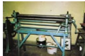
Кругло-гибочный станок для закругления плоских листов (например, при изготовлении труб).
