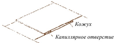
Соединение внахлестку с кожухом и капиллярным отверстием.
