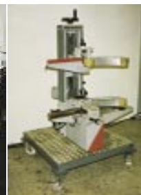
Кругло-загибочный станок. Закругленная предварительно фальцованная металлическая полоса.
