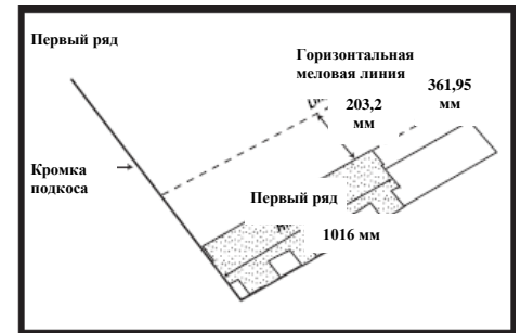
Рис. 8А Схема нанесения кровельных плиток со смещением 127 мм и 381 мм
