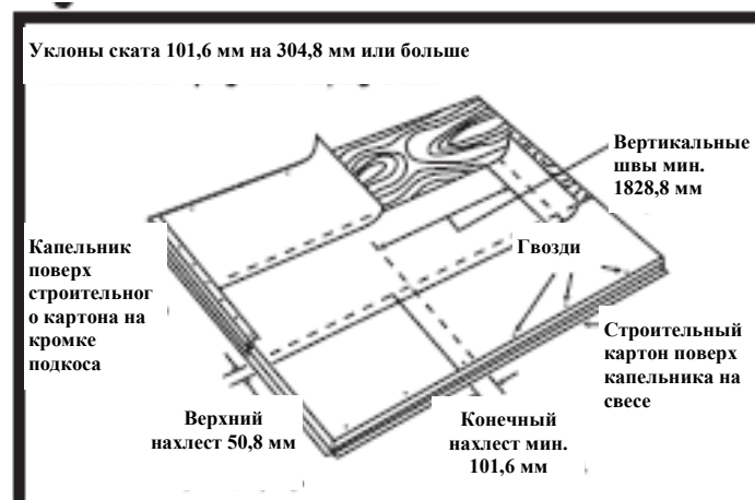
Рис. 2А Подстилающий слой для низкого уклона ската
