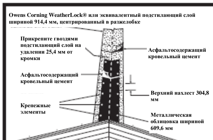
Рис. 9А Конструкция открытого разжелобка
