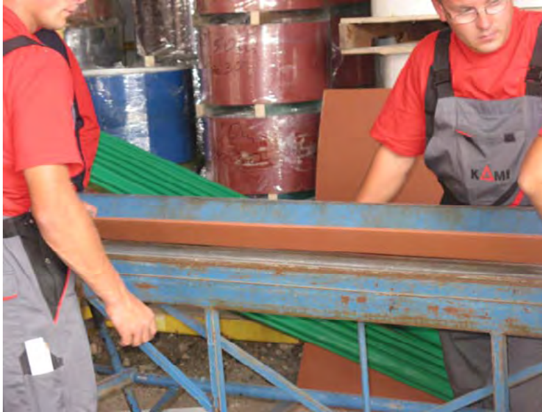
Рис.19. Изготовление планки на ручном гибочном станке
