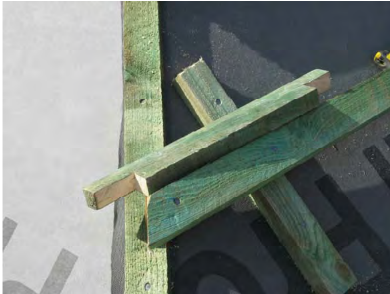
Рис.13. Шаблон для монтажа рядовых реек обрешетки
