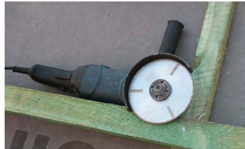
Рис.28. Инструмент для подрезания листов металлочерепицы
