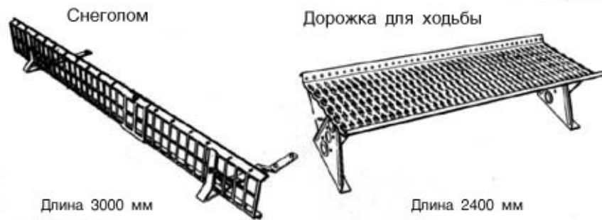
Рис. 82. Элементы безопасности: снегозадержатель и трап
