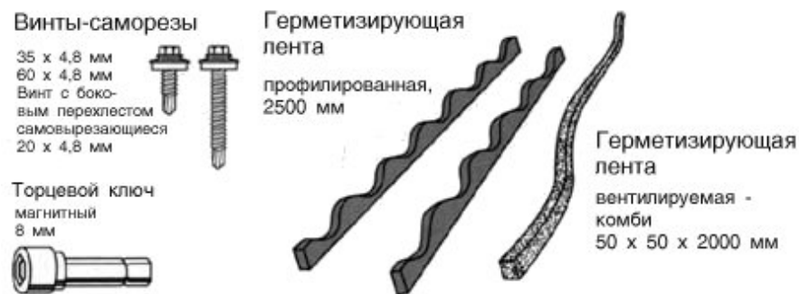
Рис. 83. Крепеж и уплотнители
