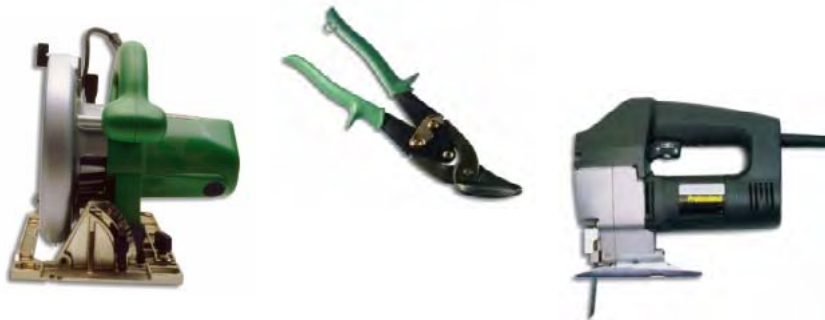
Рис.8. Инструмент для подрезки листов металлочерепицы
