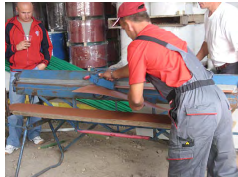
Рис.18. Разрезка плоского листа на штрипсы
