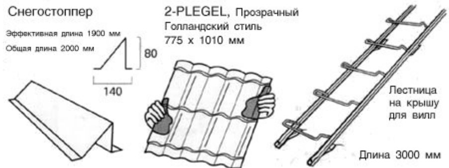
Рис. 81. Элементы безопасности: планка снегоуловителя и лестница
