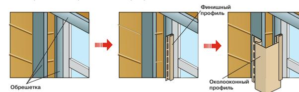
В верхнем и нижнем околонконном профиле в полках откосов надрежьте и отогните.
