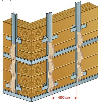
**2** Не крепите панель Holzblock насквозь. Для закрепления на панели существуют специальные оваловые отверстия. Крепеж всех горизонтальных элементов производите в центр отверстий.
