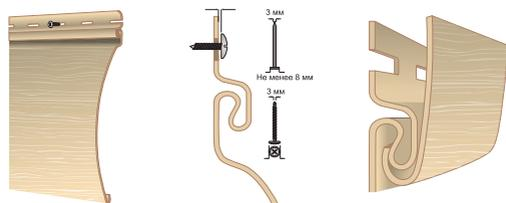
**3** Крепеж всех аксессуаров производите в центр отверстий. Первый саморез устанавливайте в верхней грани отверстия в верхней части элемента.
