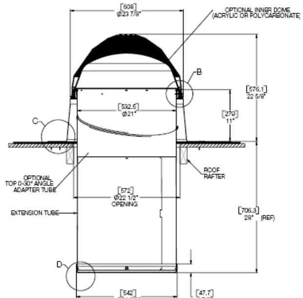
**Кольцо купола:** блокирует температурные «мостики» между пространством под флэшингом и трубой световода, является каналом, по которому выводится конденсирующаяся влага. Материал: высокопрочный ПВХ.
