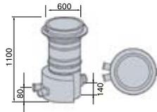
В комплект входит крышка, закрываемая «в замок» и патрубок подводящей трубы  $\varnothing$  110 мм с уплотнениями.
