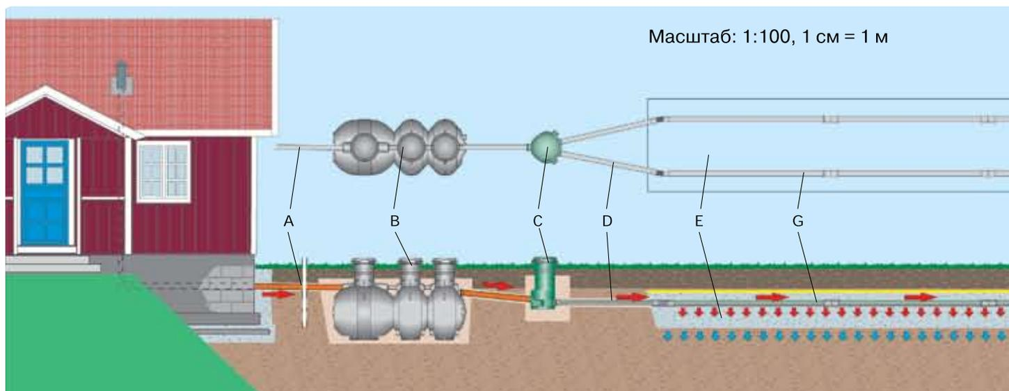
**А. Выпуск канализации** из здания к отстойнику. Укладывается в утрамбованной песчаной отсыпке. Уклон не менее 1-2 см/м. На длинных участках трубопровода необходимо устанавливать смотровую трубу или колодец.
