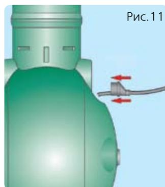
**11. Соединительная переходная деталь 110/32 мм** устанавливается как в отверстии отводящей трубы из колодца для насоса, так и в отверстии подводящей трубы в распределительный колодец.
