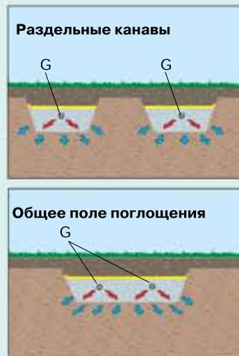
**Д. Распределительные трубы** соединяются с регулятором потока воды. Укладываются на песчаном основании. Допустимый уклон 5-10 мм/м.
