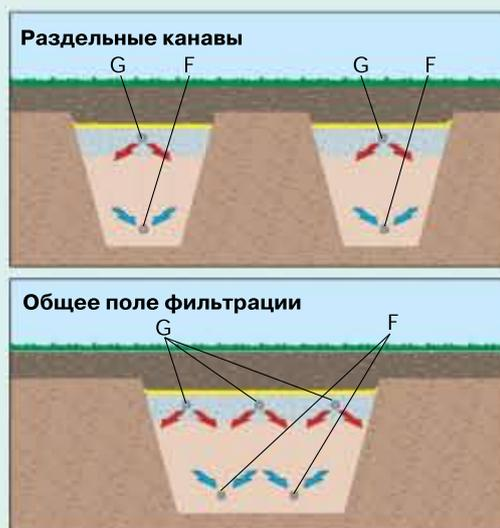
**Г. Трубы-распылители** соединяются с распределительными трубами и укладываются в слое щебня зеленой полосой вверх и отверстиями вниз с уклоном 5-10 мм/м. К противоположным концам труб-распылителей с помощью гибких отводов присоединяются отрезки распределительных труб, концы которых выводятся выше уровня поверхности земли и закрываются вентиляционными заглушками, так чтобы они располагались выше
