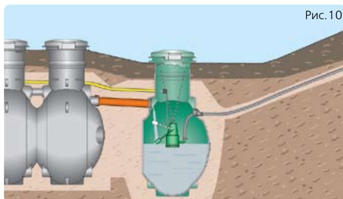
**10. Колодец для насоса** установите на горизонтальном выровненном песчаном основании. Если грунтовые воды могут подниматься выше дна колодца, закрепите его на бетонной плите основания полимерным
