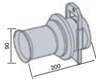
Соединительная деталь и регулирующая пластина.
