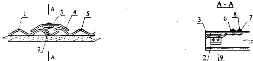
Рисунок Н.2 - Ендова кровли
