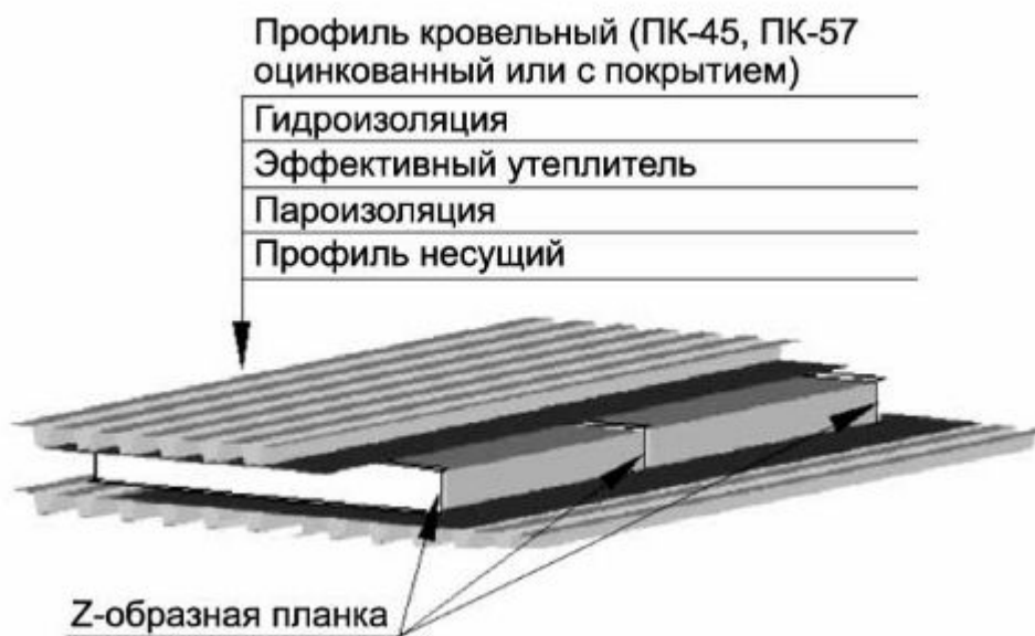
Конструкция кровли при использовании профнастила
