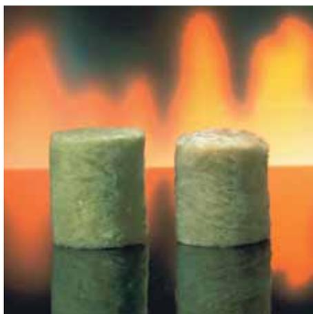
Каменная вата PAROC выдерживает очень высокие температуры. На фотоснимке приведен тестовый образец материала PAROC UNS перед и после тестирования на негорючесть по EN ISO 1182, в процессе которого тестовый образец сжигался при температуре 750 °C.
